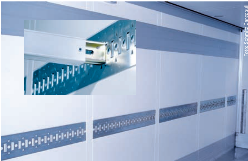
Bild 7: Auch die flächenebend auf die Seitenwände verklebten Schieneneinbauten werden für eine optimale Haftung zuvor plasmabehandelt.
