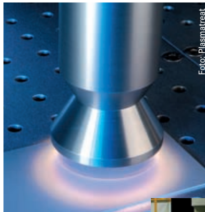
Bild 2: Das potenzialfreie Atmosphärendruckplasma trifft mit nahezu Schallgeschwindigkeit auf die Oberfläche und bewirkt deren Feinstreinigung und hohe Aktivierung.
