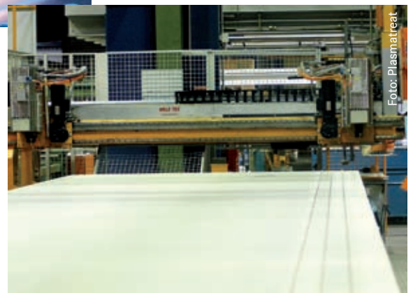
Bild 3: Die Dreiachsanlage mit dem integrierten Plasmasystem sowie dem Misch- und Dosierkopf für den Klebstoffraupenauftrag läuft vollautomatisch.
