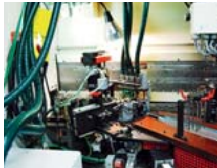
Eine normale Kantenanleimmaschine. Die Beileimstation musste der Plasmadüse weichen
