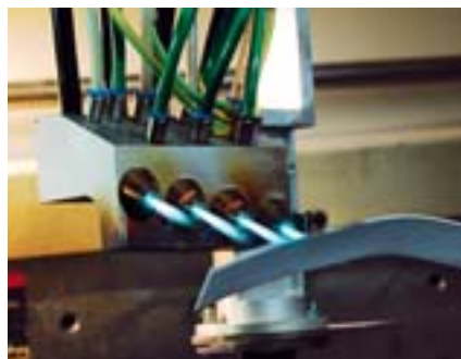
Die ausgebaute Plasmadüse: Flammen, die den Kleber der von Hand gehaltenen Kante erweichen
