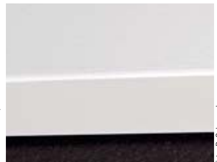
Nullfuge, bis 140 °C hitzebeständig und feuchteresistent: Mit Plasma angefahrne Kante
