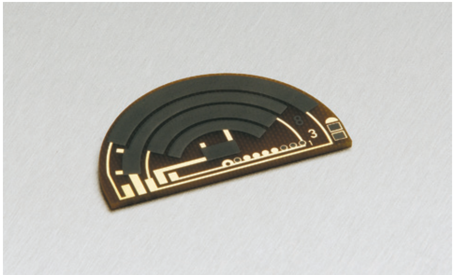
▲ Abb. 3: Die bestückten Nutzen werden nach dem Bedrucken im Ofen gebrannt und ausgehärtet. Nach der Vereinzelung erfolgt zu 100 % eine optische und elektrische Prüfung der Platinen. Bild: Plasmatreating
